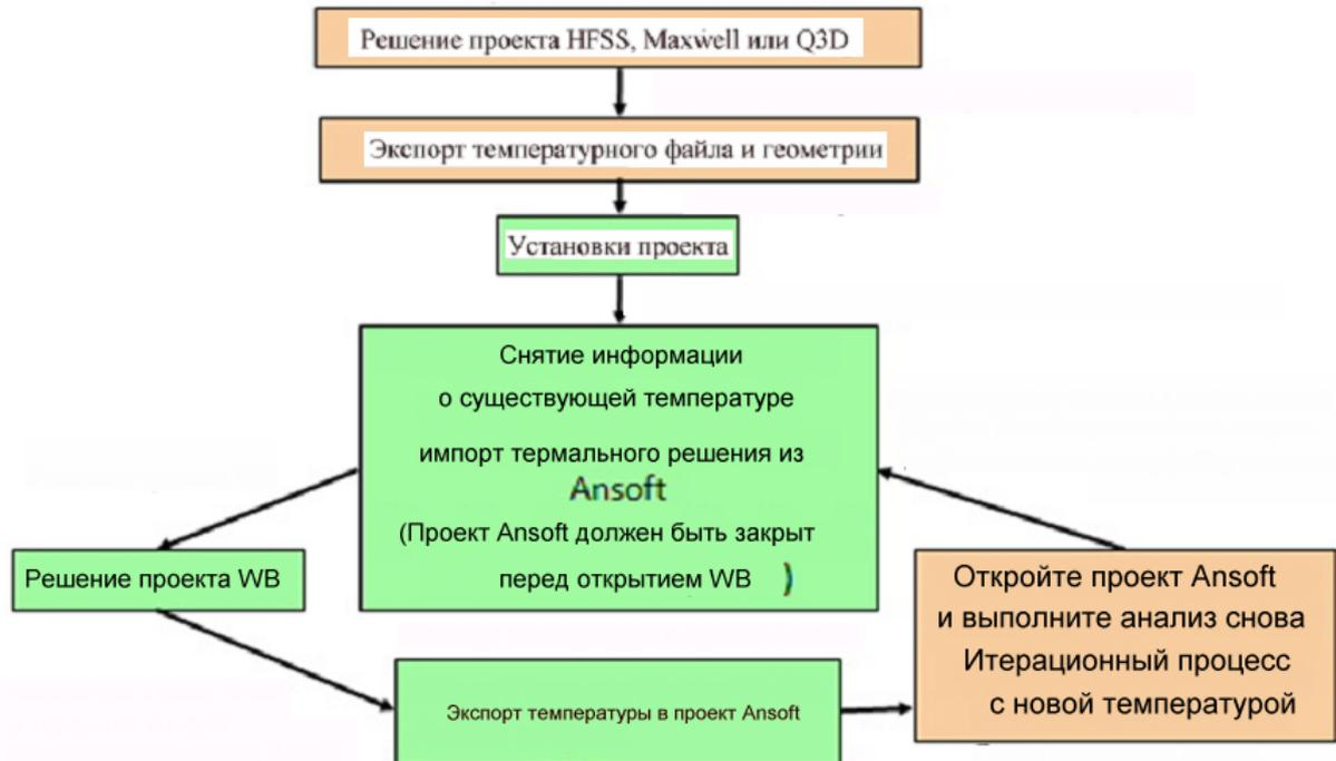
*Рис. 9.10. Расчет температурных характеристик с помощью Re-solving After ANSYS Thermal Link Feedback*
